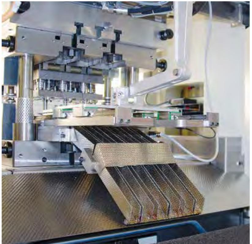
In die Pressensteuerung integriertes Ausräumgerät sorgt für beschädigungsfreie Teile
