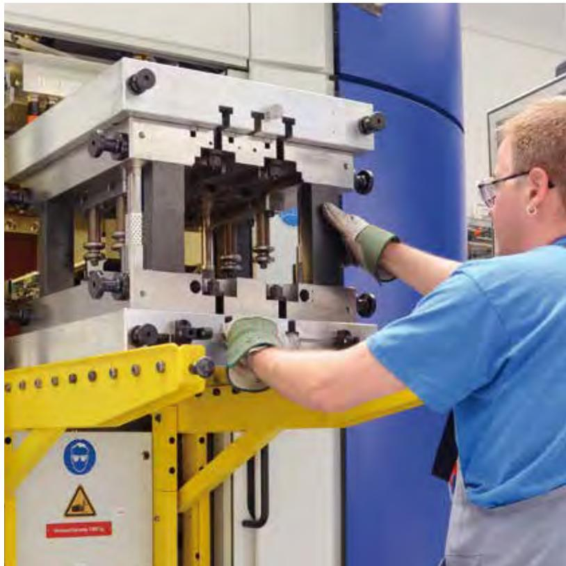
Klappkonsolen für einfachen Werkzeugwechsel
