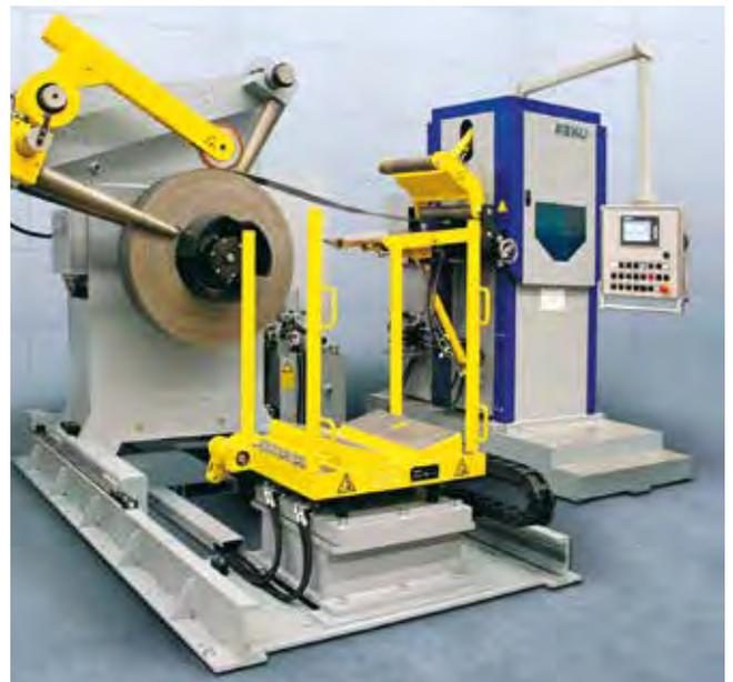
Bandrichtanlage in kurzer Langbauforn
