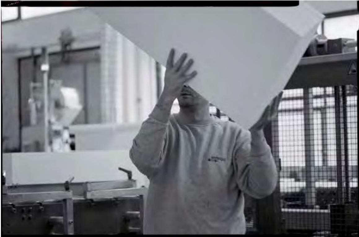
swisspor: Entnahme von EPS-Platten zur Qualitätssicherung.
